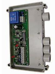
Der Router-S ist eine Platine zur Regulierung von mehreren Einheiten in einem von Sabianet gesteuertem Netz (Default), oder mittels eines Subnetzes, welches von BMS Systemen gesteuert ist, die nicht von Sabiana angeliefert sind. (Die Einstellung der Dip Switches auf der Platine darf verändert werden).
