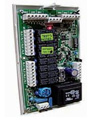
Die SIOS ist eine Platine mit 8 Relais mit potentialfreiem Kontakt zur Fernsteuerung des Ein- und Ausschaltens der Verbraucher. Die Platine verfügt über 8 Digitaleingänge zur Anzeige des Status der Stellglieder oder externer Freigaben wie die Motortemperaturen oder ähnliches.
