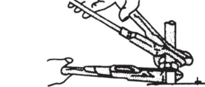
Per accedere ai collettori attacco della batteria, occorre estrarre le due griglie contigue agendo sulle viti di fissaggio.
