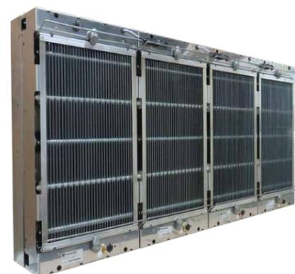
**Das erste Element ist die aktive elektrostatische Baugruppe Crystall mit Aluminiumzellen, die aus zwei getrennten und unterschiedlichen Teilen besteht, einem aktiven Teil (Polarisationsteil), der in die Trägerstruktur integriert ist, und einem passiven Teil mit einer induzierten Anode (Sammel- oder Kollektorteil), der zu Wartungszwecken entfernt werden kann.**
