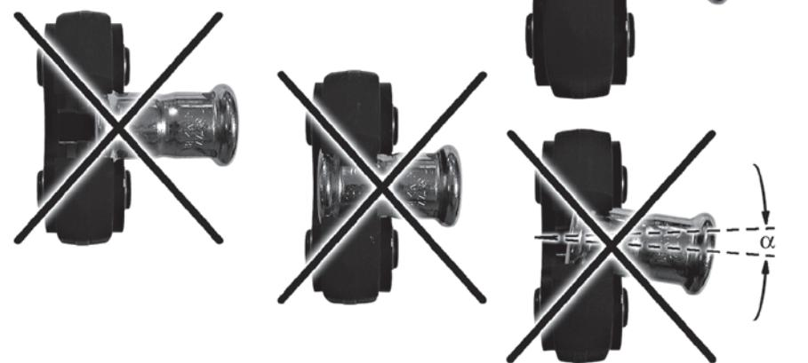
**Non pressare il manicotto a terra / Don't press the pressfitting on the floor**
