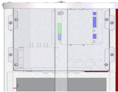
Position der Sicherung und Elektronik des Reglers ECON
